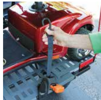
Sujetadores retráctiles con tensión autoajustable.
