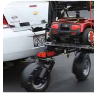
Ruedas giratorias, suspensión independiente.
