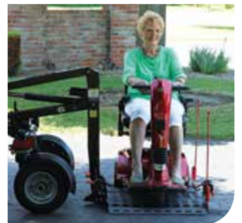
Plataforma para colocar/retirar dispositivos de movilidad.
