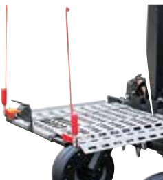
Marcadores de esquinas.
